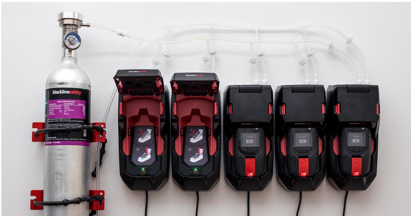
**CONFIGURAÇÃO DO G7 DOCK DE CINCO SAÍDAS** Para maior eficiência, os G7 Docks podem ser montados em configurações multidock, que acomodam até cinco G7 Docks com um cilindro de gás. Os docks podem ser instalados na parede ou colocados no tampo da mesa em qualquer lugar — não requer conexão de ethernet para os docks, todas as informações são transmitidas pelos dispositivos G7 que estão em teste. A Blackline fornece kits de tubulação para clientes que desejam implementar configurações multidock.
