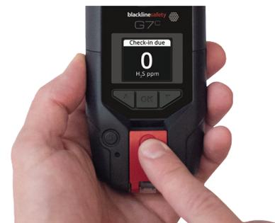
Wenn Sie in Sicherheit sind, drücken Sie die rote Hebelstaste. Wenn Sie die Hebelstaste nicht innerhalb der konfigurierten Zeit drücken, gibt ihr gelbes Rückmeldesignal einen roten Alarm an das Überwachungspersonal weiter.
