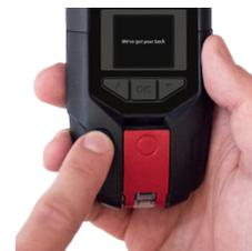
Drücken Sie zum Einschalten des G7 die Betriebstaste für zwei Sekunden. Das G7 wird einen Piepton abgeben und vibrieren, wenn es sich einschaltet.
