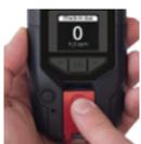
Falls es Ihnen gut geht, drücken Sie den Hebel. Dadurch kehrt das G7-Gerät in seine normale Betriebsfunktion zurück.
