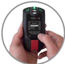
**A :** Utilisez les flèches haut et bas pour accéder au test de fiabilité ou à l'étalonnage à partir du menu principal.
