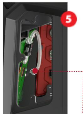
2. Verwenden Sie einen Philips Schraubendreher, um die drei Schrauben zu entfernen, die das Diffusionsmodul am EXO-Körper halten.
