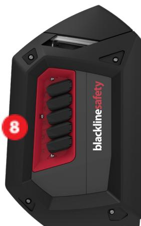
8. Verwenden Sie die drei Schrauben, um das Pumpenmodul zu befestigen.
