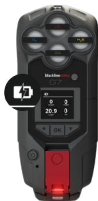
Ist das PowerPack am G7 angebracht, so wird die Ladeanzeige unten am G7 aufleuchten und das Akku-Symbol wird einen Blitz anzeigen, um das Laden von G7 anzugeben.
