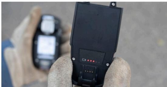
PowerPack ist am G7 angebracht, damit das G7-Akku während der Schicht länger in Betrieb in.
