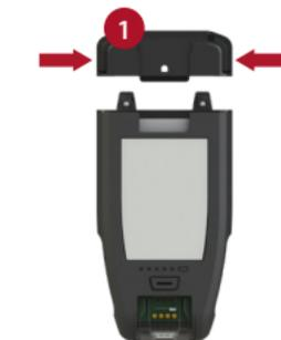
1. Sbloccare il gancio PowerPack dal PowerPack premendo verso l'interno sulle linguette di rilascio
