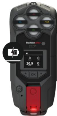
Quando PowerPack è collegato a G7, la spia di ricarica si illuminerà sulla base di G7 e sull'icona della batteria apparirà un fulmine per indicare che G7 si sta caricando.
