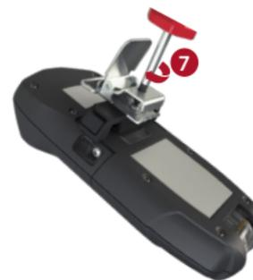
5. Allineare il foro della vite nel gancio di PowerPack con il foro sul retro di G7
