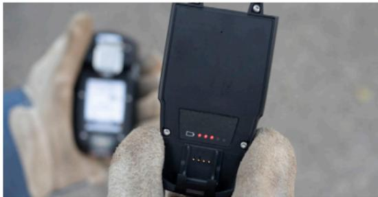
PowerPack viene collegato a G7 per far durare di più la batteria di G7 durante il turno.
