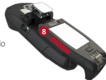
5. Alinhe o orifício do parafuso no fecho PowerPack ao orifício na parte traseira do G7
