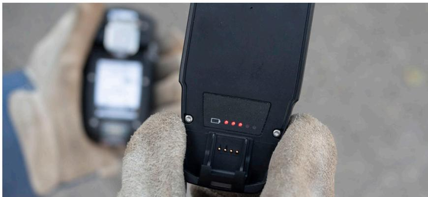
PowerPack kann am G7 angebracht werden, damit der Akku Ihres Geräts während der Schicht länger in Betrieb ist. Das angebrachte PowerPack lädt und betreibt G7 gleichzeitig – wenn PowerPack eine Akkudauer von 0 % erreicht, beginnt sich das G7-Akku zu entleeren.
