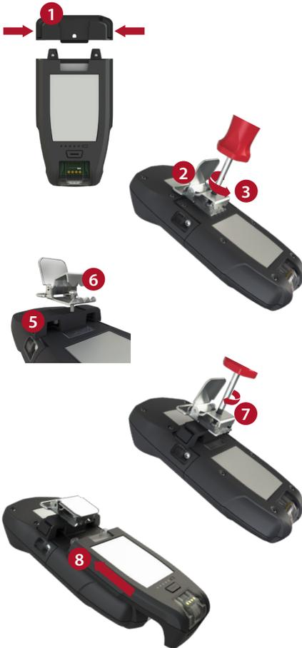
1. Die Klemme von PowerPack entfernen, indem auf die Freigabeauslöser nach innen gedrückt wird und beide voneinander weggezogen werden
