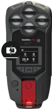
Ist das PowerPack am G7 angebracht und geladen, so wird die Ladeanzeige unten am G7 aufleuchten und das Akku-Symbol wird einen Blitz anzeigen, um das Laden von G7 anzugeben.
