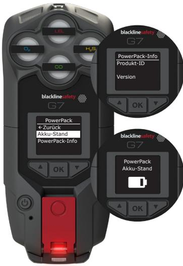
In der Option *PowerPack-Info* können Sie Einzelheiten wie die Produkt-ID von PowerPack (außerdem verfügbar auf dem Geräteschild auf der Rückseite des Akkus) sowie die vom Akku verwendete Firmware-Version anzeigen.
