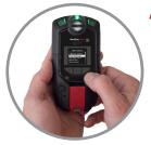
A: Usare i pulsanti freccia per navigare nel menu principale ed effettuare il bump test o la calibrazione
