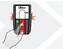
Betätigen Sie den Riegel, wenn bei Ihnen alles OK ist. Die Weiterleitung des örtlichen Alarms wird gestoppt.
