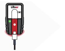
Ein durchgängig rotes Leuchten zeigt an, dass das Gerät vollständig geladen ist.
