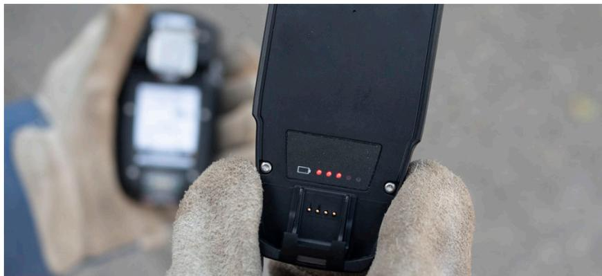
El PowerPack puede acoplarse al G7 para ayudar a que la batería de su dispositivo dure más durante su turno. Cuando está conectado, el PowerPack carga y opera simultáneamente el G7. Cuando el PowerPack alcanza el 0 % de duración de la batería, comenzará a consumirse la batería del G7.
