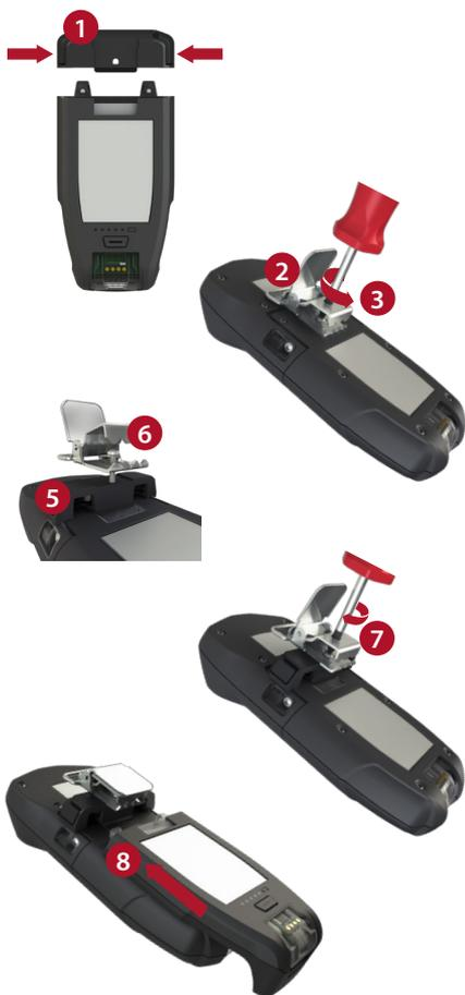
1. Libere el sujetador del PowerPack presionando hacia adentro en las lengüetas de sujeción y retire
