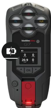
Cuando el PowerPack está acoplado al G7 y está cargado, la luz de carga de color rojo se enciende en la parte inferior del G7 y el icono de la batería mostrará un rayo que indica que el G7 se está cargando.
