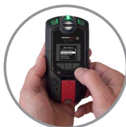
**A:** Utilice las flechas hacia arriba y hacia abajo para desplazarse hasta la prueba de funcionamiento o el calibrado desde el menú principal.
