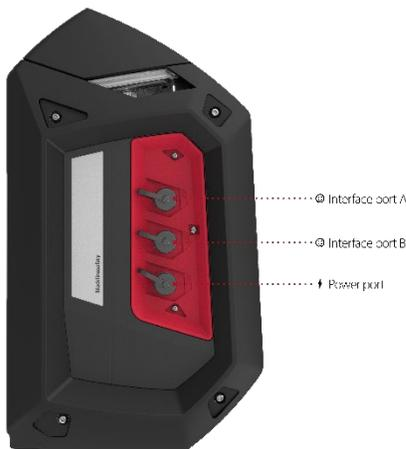
È possibile acquistare un kit per la carica compensativa EXO da Blackline Safety. Il kit collega EXO direttamente a una fonte di alimentazione tramite la porta di alimentazione, eliminando la necessità di spegnere e rimuovere EXO dal campo per caricare il pacco batteria. Consultare il paragrafo 13.3 per ulteriori informazioni sulla porta di alimentazione.
