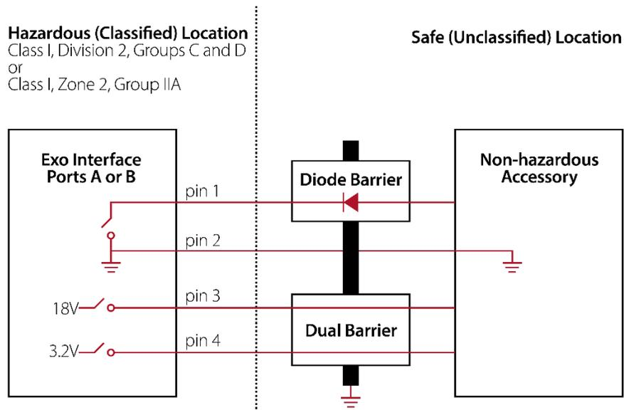
**NOTA:** è necessaria una barriera per ogni porta dell'interfaccia. Il diodo a barriera e la doppia barriera possono essere unità singole o un'unità congiunta.
