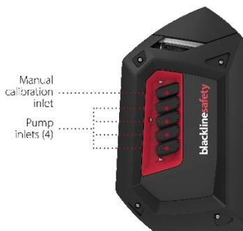
L'ingresso di calibrazione manuale è l'ingresso tramite il quale il gas viene applicato ai sensori di EXO 8 durante i bump test e la calibrazione.
