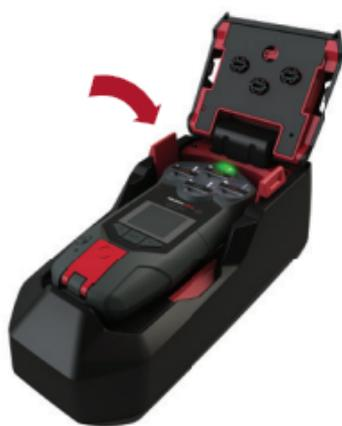
2. En maintenant les attaches de charge connectées, insérez l'appareil G7 dans la station et appuyez jusqu'à ce qu'il s'enclenche.
